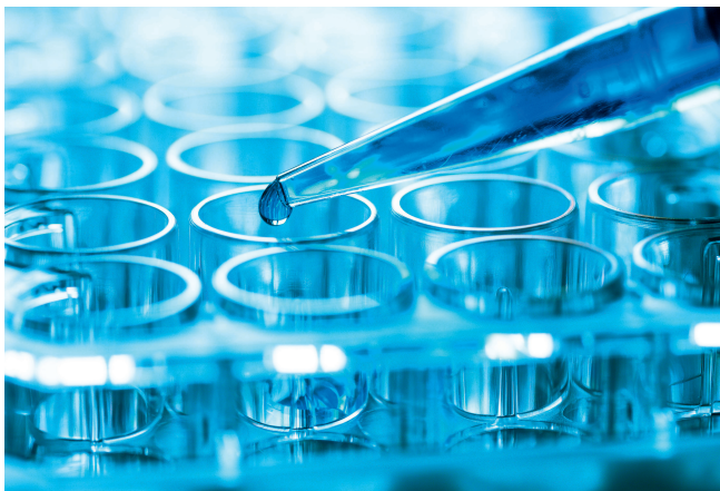
Bild 2. Für medizinische Ausrüstung eignen sich Styrol-kunststoffe aufgrund ihrer Festigkeit und Steifigkeit, ihrer chemischen Beständigkeit und der Möglichkeit der Transparenz sehr gut
