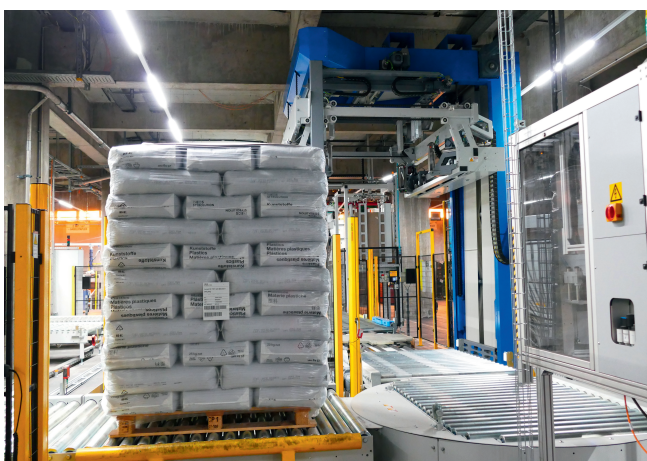
Bild 3. Stretchhauben schützen Waren auf Paletten beim Transport. Sie müssen deshalb aus Polymeren bestehen, die für eine hohe Elastizität und Schlagfestigkeit sorgen © Ineos Styrolution
